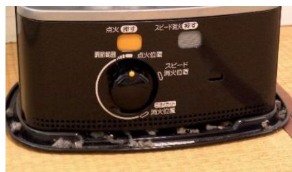
(掃除不足の例) 置台にたまったほこり
