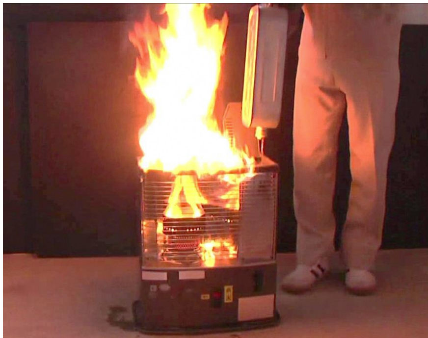
タンクから漏れた灯油に引火（再現実験）
