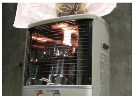
燃焼筒のずれによる異常燃焼
