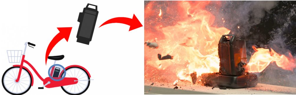
電動アシスト自転車用非純正バッテリーから発火する様子（再現イメージ） （※資料中の全ての画像は実際の事故とは関係ありません。）
