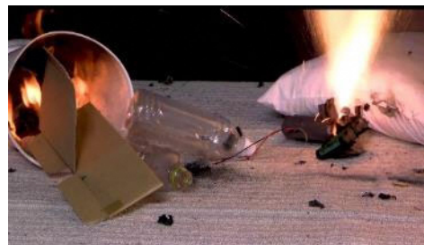
充電式掃除機用非純正バッテリーの発火 (再現イメージ)
